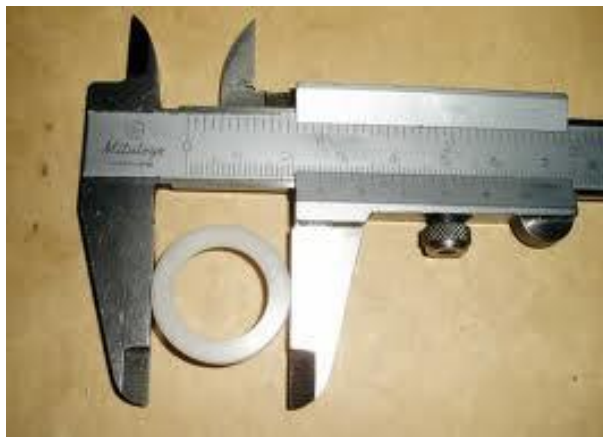
Figura 27. Pie de rey con bocas de medición exteriores e interiores
