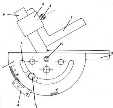
Partes 1. Limbo 2. Tornillo de fijación 3. Vernier 4. Sector 5. Cursor auxiliar
