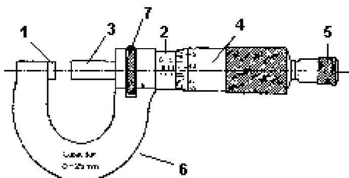
1. Tope fijo 2. Cilindro graduado 3. Vástago de medición 4. Tambor 5. Dispositivo regulador de la fuerza de medición 6. Herradura . 7. Tuerca de fijación
