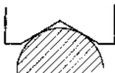
Hay niveles con base de apoyo graduables hasta un valor de ángulo de inclinación bastante elevado; así, la base puede formar un ángulo de inclinación de hasta  $50^{\circ}$  con el plano horizontal determinado por la burbuja.
