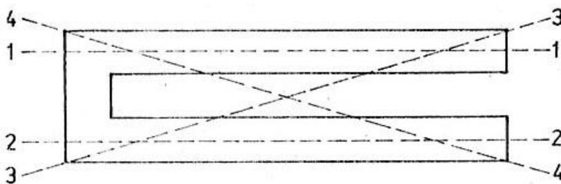
Determinación de la planicidad y rectitud de las superficies de medición de las reglas fijas, auxiliares y de las escuadras auxiliares (1,2 longitudinales; 3,4 diagonales).
