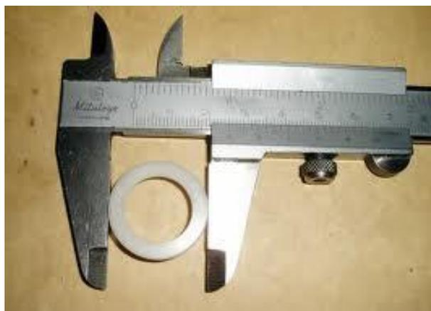
Figura 27. Pie de rey con bocas de medición exteriores e interiores
