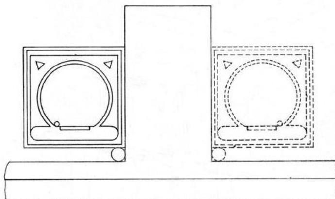
Dispositivo en forma de “T” con caras planoparalelas para la comprobación de la posición cero de la burbuja de los niveles de cuadro respecto a sus superficies planas laterales.
