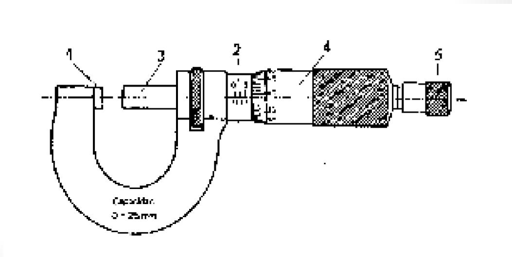
Como puede verse en ella, está formado por un cuerpo en forma de herradura en uno de cuyos extremos hay un tope o punta de asiento (1); en el otro extremo hay fija una regla cilíndrica graduada en medios milímetros (2) que sostiene la tuerca fija (no visible en la figura); el extremo del tornillo tiene forma de varilla cilíndrica y forma de tope (3), mientras que su cabeza está unida al tambor graduado hueco (4).
