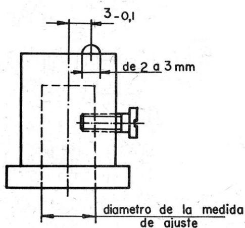
Después, la medida de ajuste se coloca con ayuda de casquillos entre las superficies de medición del micrómetro, se hace el contacto con la superficie de las bolas y se toma la lectura por la escala del micrómetro.
