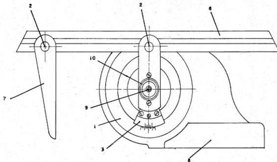
Partes: 1. Limbo 2. Tornillo de fijación 3. Vernier 6. Regla auxiliar 7.
