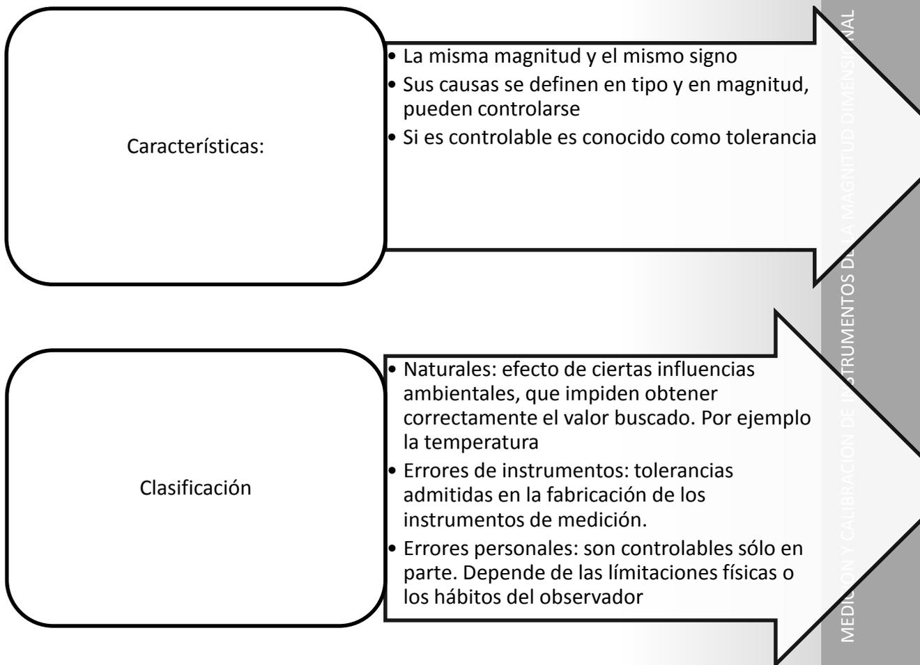
Figura 11. Errores sistemáticos
