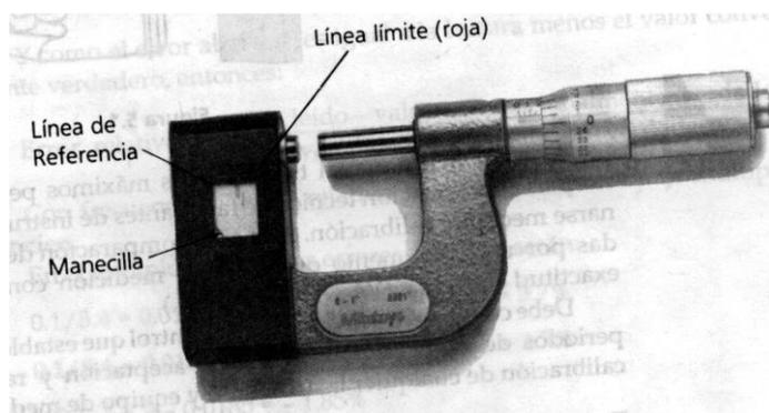
Figura 13. Micrómetro de exteriores
